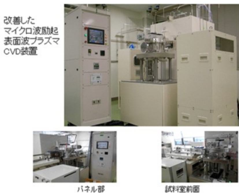
図. 低温・高速成膜可能なマイクロ波励起表面波プラズマ CVD 装置
